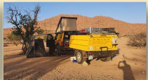
Toyota LandCruiser HDJ80 Spezial mit permanentem Allrad, 3 Sperren, Geländereduktion, 2 Standheizungen, Computeranlage, GPS-Navigation, Satellitentelefon, Winde, Schnorchel, Aufstelldach, Küche + Bettinnenusbau, 2 x CB, KW UKW Funkanlagen, Zusatzdieseltank (200 Liter), Solaranlage, Zusatzbatterie für Innenraum, 120 Liter Trinkwassertank, Trinkwasseraufbereitung, Zusatzstromversorgung über Dieselaggregat 6,5 KW ...
